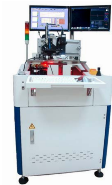
图01 Shining Technologies的多点LED测试系统
